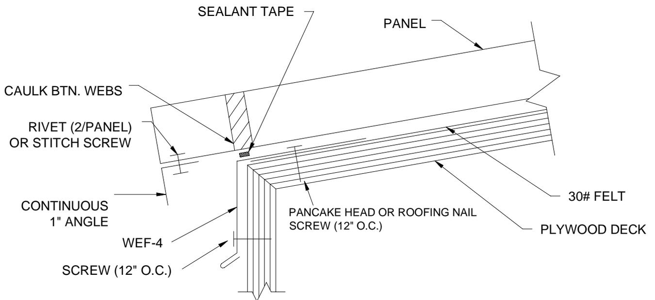
NOTE: POP-RIVETED ANGLE MUST NEVER CONTACT EAVE FLASHING.
